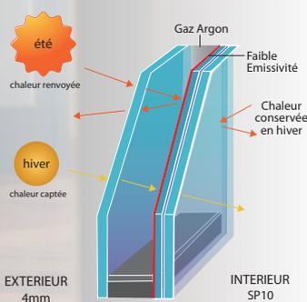
La performance de protection au froid d'un vitrage isolant est donnée par sa valeur  $U_g$ , coefficient de déperdition de chaleur exprimé en  $watt/m^2.K$ .
